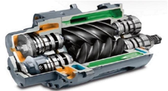
Funcionan a altas velocidades y combinan la elevada capacidad con pequeñas dimensiones. Son lubricados mediante aceite, que al mismo tiempo es utilizado para sellar las fugas de aire. Existen **compresores de este tipo exentos de aceite (*oil-free*)**, que son utilizados cuando la calidad del aire comprimido requiere teóricamente nula la presencia de partículas.
