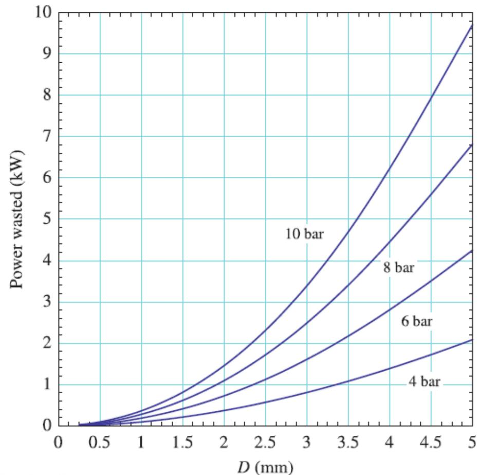
Potencia disipada vs diámetro de la fuga
