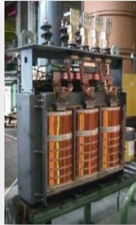
Transformador sin su cuba
