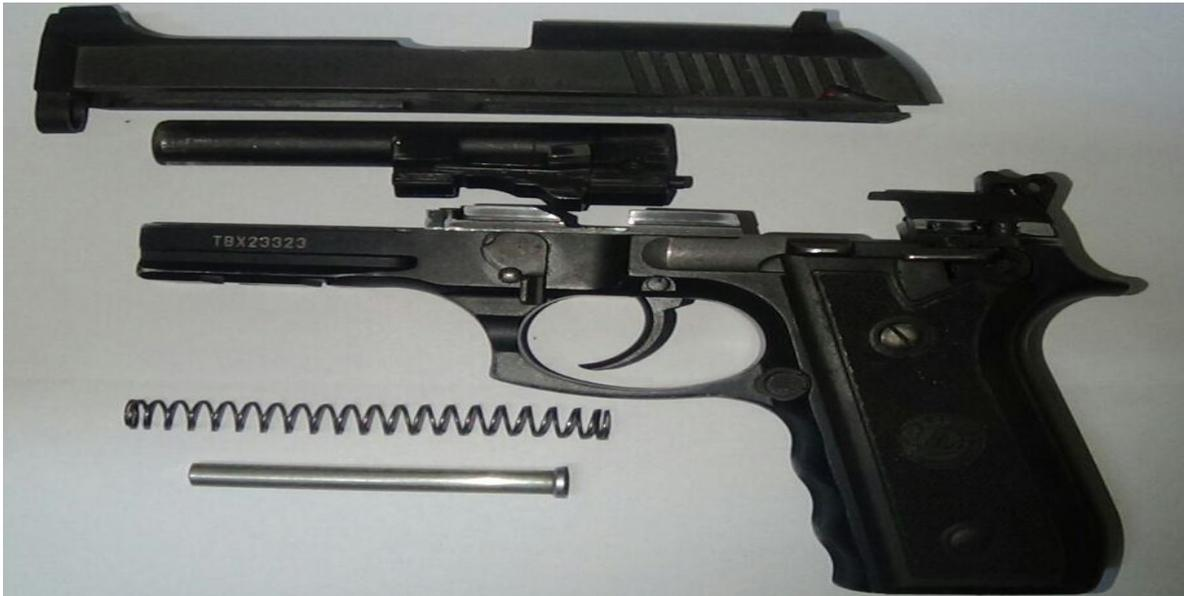
Este modelo de pistola Taurus cuenta con distintos dispositivos de seguridad, la traba del percutor queda permanentemente bloqueando el desplazamiento del mismo hacia el frente, impidiendo disparos caso suceda una caída del arma. La traba del percutor solamente es liberada en la etapa final del accionamiento del disparador, liberando el desplazamiento del percutor.
